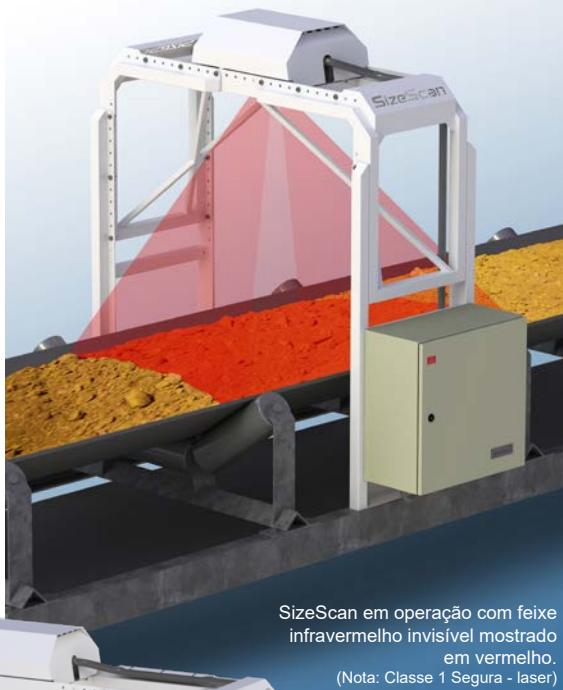
A estrutura do pórtico ajustável do SizeScan se adapta a uma ampla gama de larguras de transportadores e alturas de materiais.
