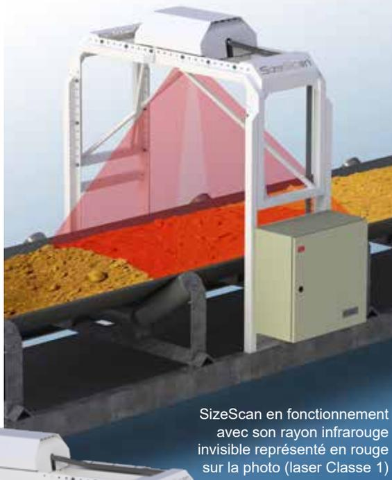
SizeScan en fonctionnement avec son rayon infrarouge invisible représenté en rouge sur la photo (laser Classe 1)
